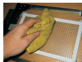
3. Entsorgung der alten Vliese und Säubern des Polarisationsgitters.
